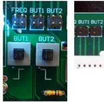
Figure 25 Button tạo xung lên và xung xuống, Top and Bottom Connector
